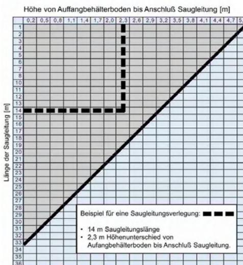
Die Tabelle links stellt das Verhältnis Länge der Saugleitung zu Höhe vom Auffangbehälterboden (z. B. Zisterne/ Erdbehälter) bis Anschluß-Saugleitung dar. Bei Installation der Saugleitung ist eine möglichst geringe Höhen- und Längendifferenz einzuhalten.
