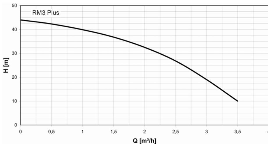
Diese Übersicht basiert auf einer kinematischen Viskosität von 1 mm<sup>2</sup>/s und einer Dichte von 1.000 kg/m<sup>3</sup>.
