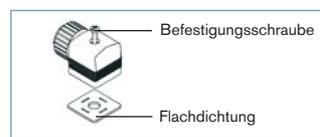
Zum Lieferumfang einer Gerätesteckdose gehören Flachdichtung und Befestigungsschraube. Für weitere Ausführungen siehe separates Datenblatt Typ 2508.
