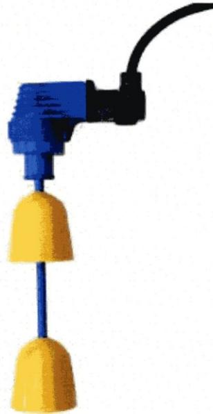
**Bitte beachten Sie bei der Einstellung der Schaltepunkte, den für die Pumpe erforderlichen Mindestwasserstand beim Einsschalten sowie den minimal möglichen Wasserstand beim Ausschalten der Pumpe. Hinweise dazu finden Sie in der Betriebsanleitung der Pumpe. Nach Veränderung der Einstellung des Schwimmerschalters prüfen Sie bitte einige Schaltschritte um einen einwandfreie Funktion sicherzustellen.**
