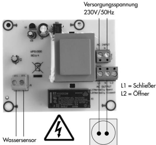
Schaltungsänderungen dürfen aus Sicherheitsgründen nur von einer fachkundigen Person ausgeführt werden. Dabei muss das Gerät komplett vom Stromnetz getrennt sein!
