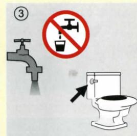
Bevor das defekte Schwimmerventil ausgebaut werden kann, gehen Sie wie folgt vor:
