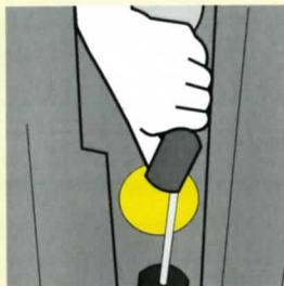
Das eingedichtete Ventil durch die obere große Öffnung von innen durch die Ventilbohrung stecken und den Messingsechskant von außen auf das Ventil schrauben. Handfest anziehen.
