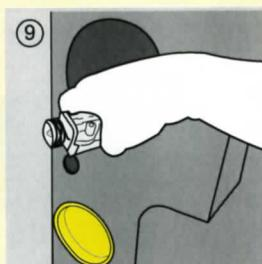
Nach dem Eindichten des Außengewindes ist das neue Ventil "einbaufertig".
