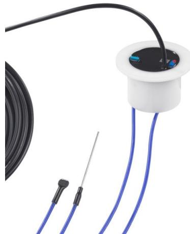
Der **Zisternen-Geber RWS 5V (IP 65, Nr. 9760)** ist vorzugsweise für den Einsatz von Zisternen (im Erdreich) konstruiert. **Für Wassertiefen 1-3 m.** Er wird einfach oberhalb der maximalen Wasserlinie montiert. Der Geber ist mit einer 20 m langen, 2-adrigen Mantelleitung zum Anschluss am Steuergerät ausgestattet und voll vergossen. Abmessung: B=80 mm, L=80 mm, T=50 mm Montage über den Gehäuseflansch
