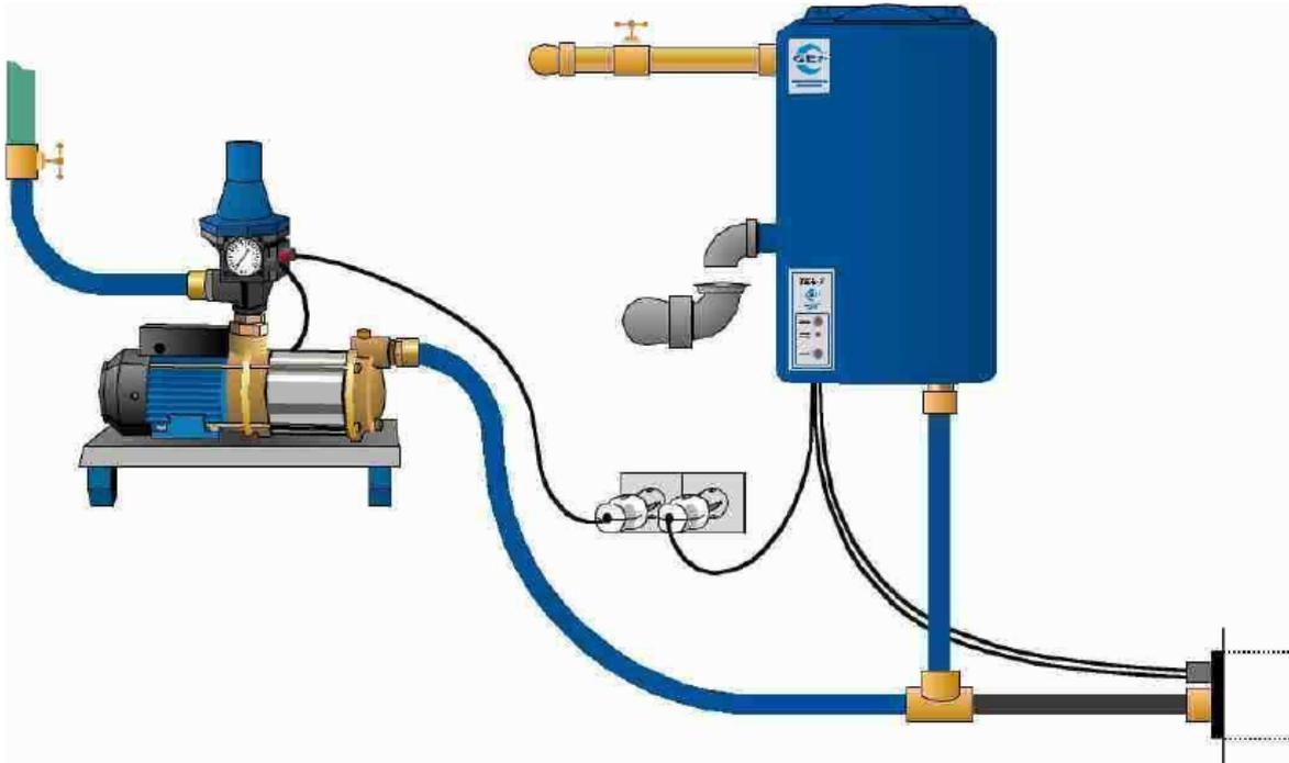
Dieses Schema zeigt die Kombination einer Systemsteuerung TEA mit einem Hauswasserwerk ASPRI mit KIT
