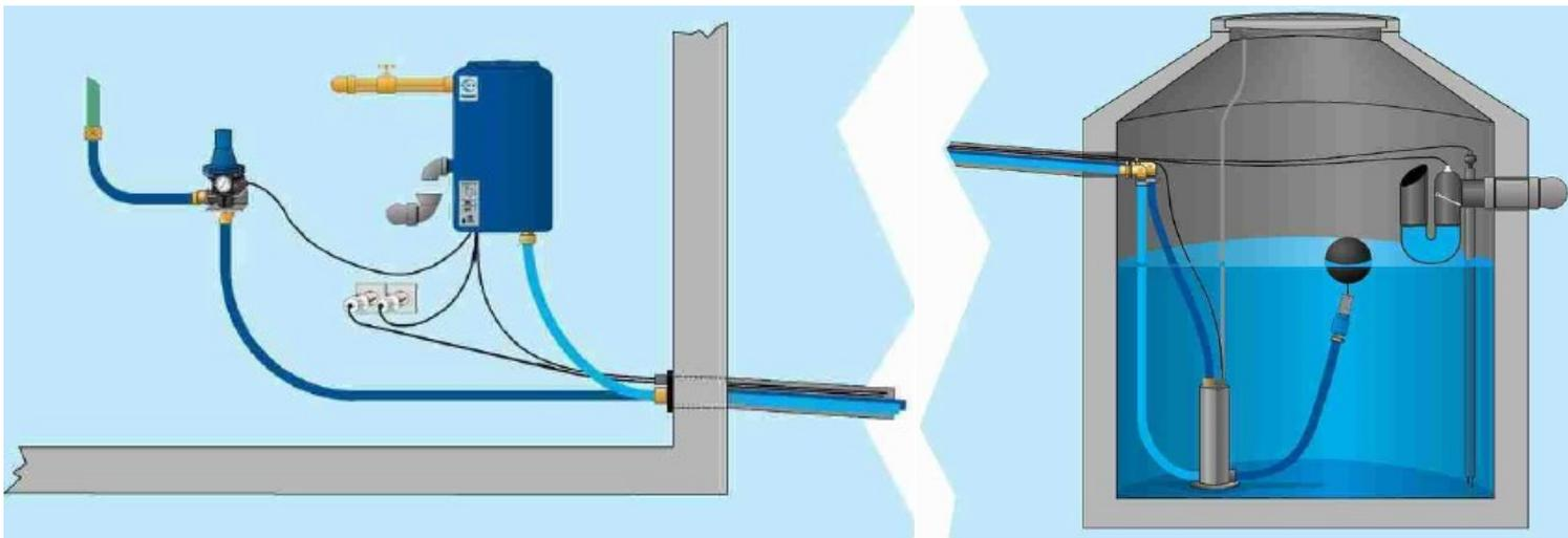
Dieses Schema zeigt die Kombination einer Systemsteuerung TEA mit einer Tauchpumpe Combipress.
